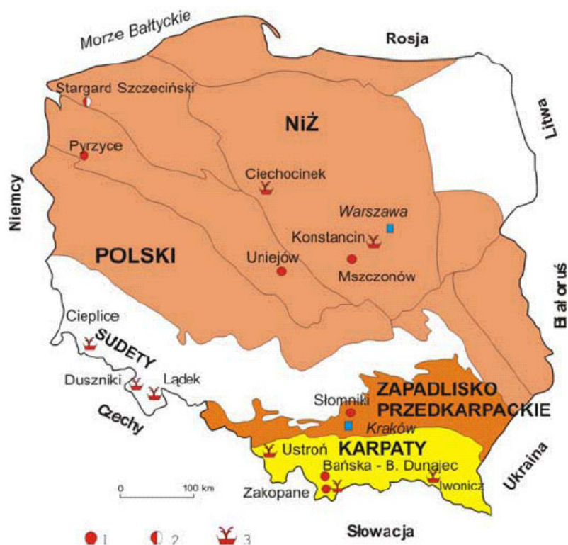
Rysunek 3-2 Zasoby geotermalne, funkcjonujące i planowane zakłady geotermalne w Polsce. Zakłady geotermalne: 1-funkcjonujące, 2-planowane, 3-uzdrowiska. (podział na prowincje i zasoby wg. Sokółowskiego)
